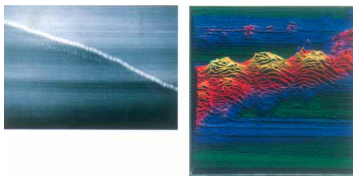
Abb. 1. Links: Ein Quantendraht, der sich aus einer Lösung von 1 bildete und der durch Zufall mit Raster-Tunnel-Mikroskopie (STM) entdeckt wurde. Der Durchmesser der einzelnen Teilchen beträgt etwa 6 nm. Dies stimmt mit einem Aggregat von 13 Clustermolekülen 1 , einem [(\mathbf{1})_{13}] -Supercluster, überein. Rechts: Ein vergrößerter Abschnitt dieses Quantendrahts, der drei Supercluster umfaßt.
